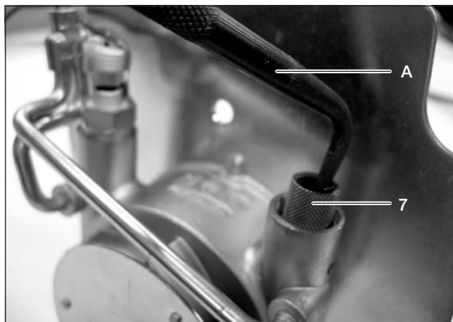
A Острый предмет для извлечения обкладки 7 Обкладка патрубка свечи
