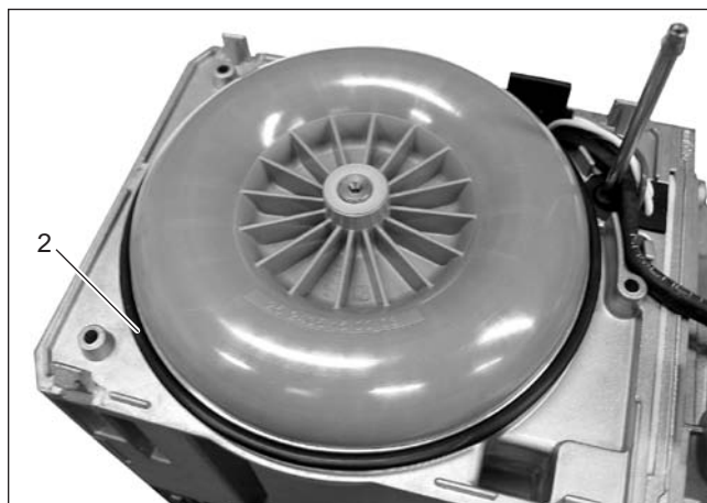
2 Уплотнительное кольцо, наложенное на блок управления/блок нагнетателя Рис. 32
