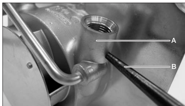
Рис. 34 A Правый патрубок свечи B Острый предмет для чистки отверстия для подачи воздуха зажигания.
